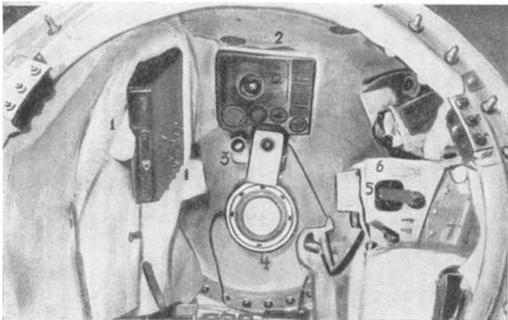
*Кабина космонавта: 1 – пульт пилота; 2 – приборная доска с глобусом; 3 – телевизионная камера; 4 – иллюминатор с оптическим ориентатором; 5 – ручка управления ориентацией корабля; 6 – радиоприёмник; 7-контейнеры с пищей.*
